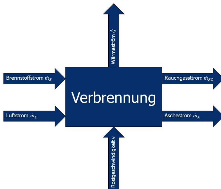
Abbildung 4 – Einflussgrößen und resultierende der Verbrennung
